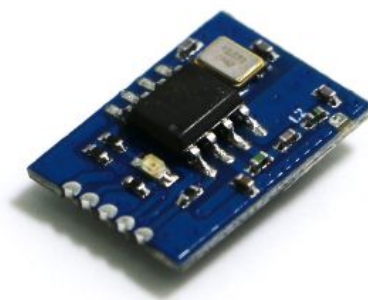
图：配套标准 6 键发射模组
